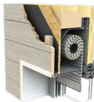
Pose sur maison ossature bois
