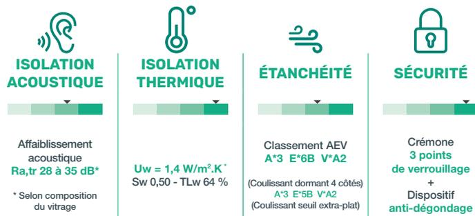
\* Coulissant 2 vantaux avec double vitrage faiblement émissif (Ug = 1,1 W/m2)
